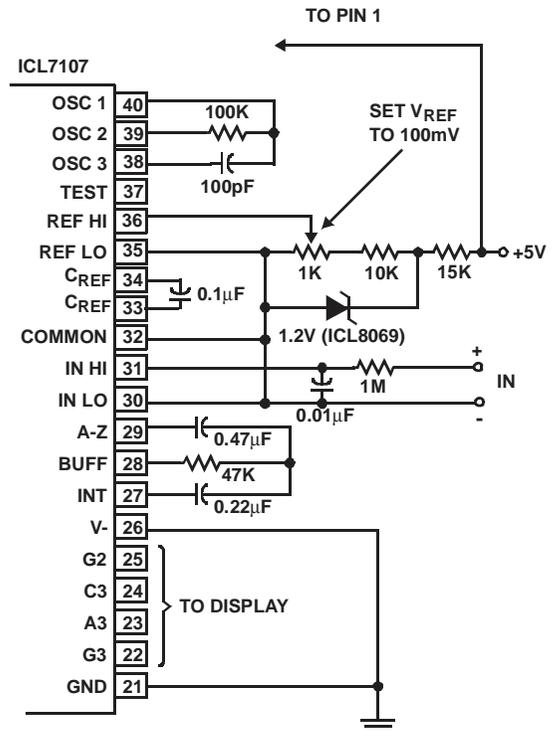
FIGURE 1. ICL7107 OPERATED FROM A SINGLE +5V SUPPLY
